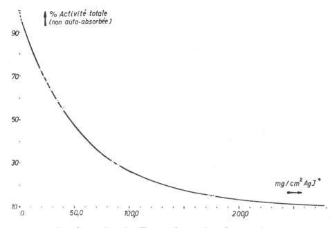
Fig. 2. — Courbe d'auto-absorption dans Agl.
