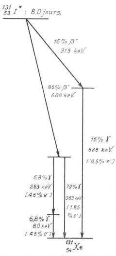
Fig. 1. — Schéma de désintégration d'I-131.
