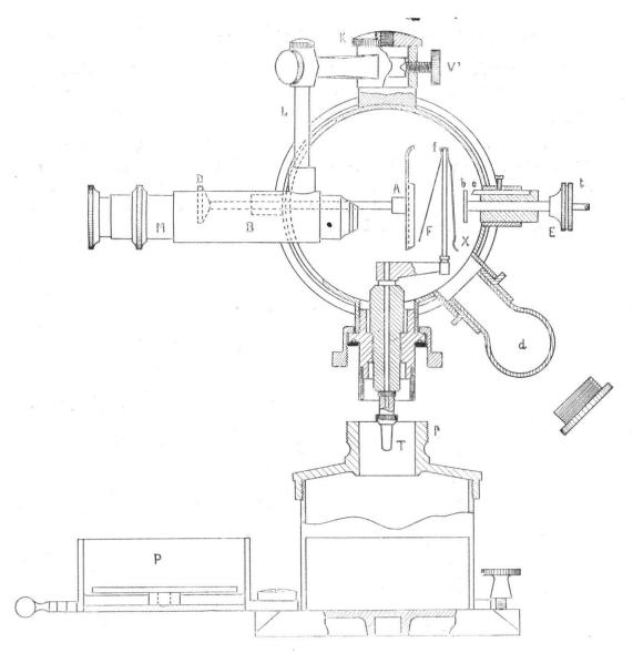
Fig. 4. — Schéma de l'électroscope de Curie (mod. Cheneveau-Laborde).
