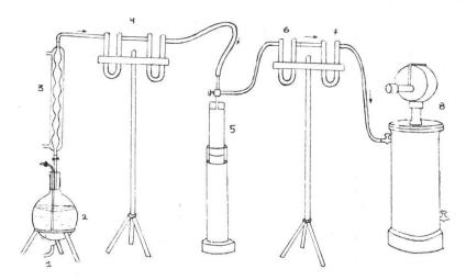
Fig. 2. — Dispositif utilisé pour l'extraction du radon et la mesure de l'ionisation '.
