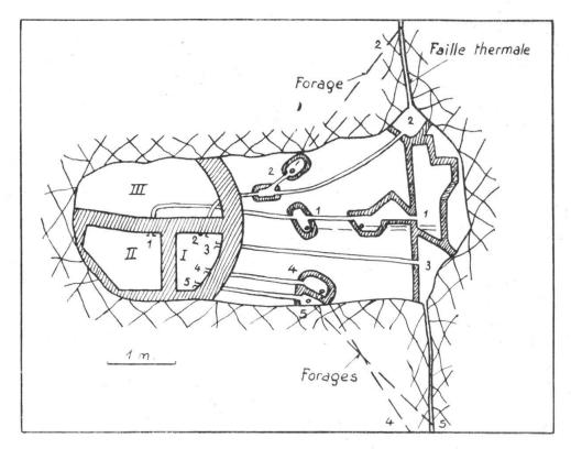
Fig. 2. — Plan du captage de Lavey-les-Bains (cote -28,00).
