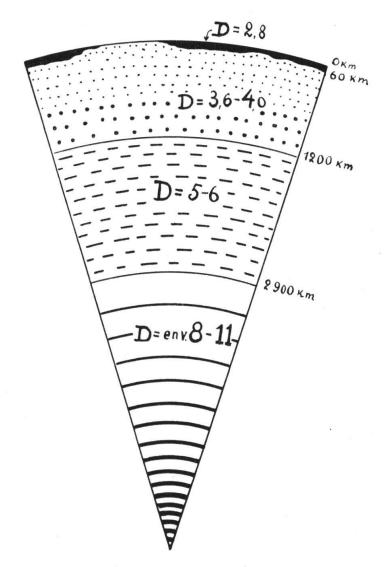
Fig. 1. — Segment découpé dans la terre et figurant sa structure d'après les recherches séismiques.
