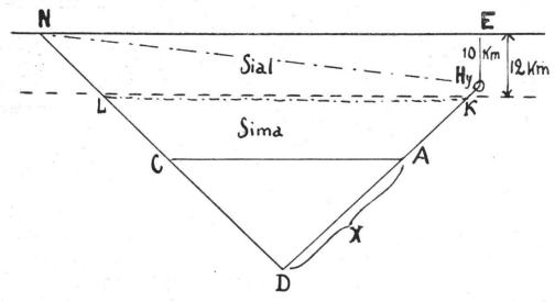
Fig. 2. — Construction qui permet de déterminer l'épaisseur du Sial suivant le profil de Neuchâtel, dans l'hypothèse que le Sial est homogène, que  $V_{\text{Pg}} = 5.78 \text{ km/sec}$  est valable dans toute sa masse, que  $V_{\text{Sima}} = 8 \text{ km/sec}$  et que la surface de séparation entre le Sial et le Sima est horizontale.
