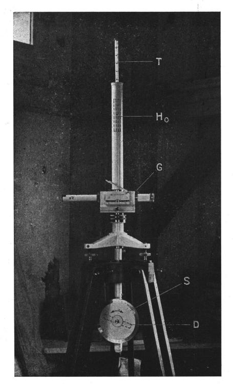
b. Instruments de contrôle continu des variations du champ magnétique à la station de base.
