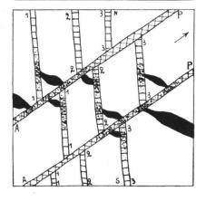
Fig. 4. — Sectionnement d'un ancien filon métallisé produit par les orogénèses hercynienne et alpine. Appauvrissement de chacun des tronçons, ainsi formés, par l'intervention des eaux qui circulent suivant les plans des failles.
