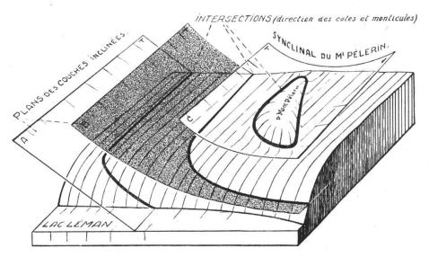
Fig. 8. — Bloc perspective schématique de la région du Mont-Pélerin. Les plans idéaux A, B, C, sont ceux des couches, inclinées en A, se courbant en synclinal en B et C, dont les intersections avec la surface du terrain (plateau et versant lémanique) sont représentés en traits noirs épais. Ces intersections ou lignes d'affleurement des bancs durs expliquent les courbes des côtes et buttes de la fig. 7.
