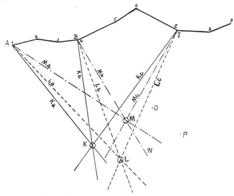
fixons, à l'aide d'une épingle, l'origine des rayons visuels, au point A de la carte. Faisons de même pour les points B, C,... Les rayons Ka, Kb, Kc,... doivent déterminer, par leur intersection, la position du point K, sur la restitution. Mais il est clair qu'en faisant pivoter les rayons Ka, Kb, Kc,... autour des points A, B, C,... nous pouvons obtenir une infinité de positions de leur croisement dans un seul point. Autrement dit, la position du point K, sur la restitution, reste indéfinie.
