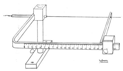
Fig. 5. — Appareil de E. Landau permettant de fixer partout sur l'hémisphère le point de l'axe.
