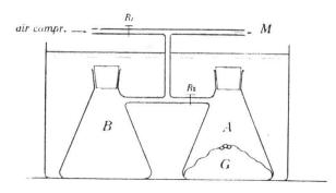
Fig. 1. — Schéma de l'appareil pour déterminer la compressibilité.
