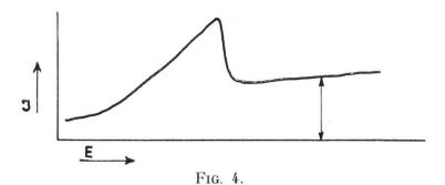
En milieu ammoniacal, Ni se réduit sur la cathode de mercure à —1,2 V environ. En solution diluée, le nickel, comme la plupart des métaux, présente un «maximum» sur sa courbe polarographique (fig. 4).
