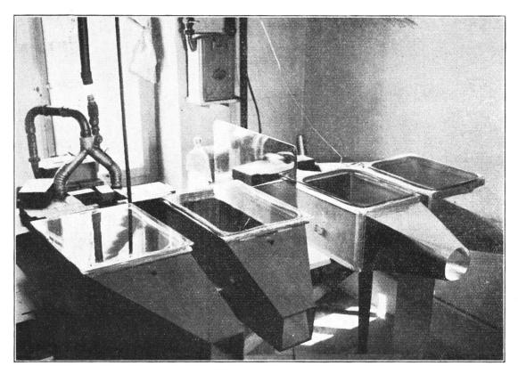
Fig. 12. — Nouvelle installation de courants d'air différemment ionisés. A gauche, les atmosphères normale et surionisée; à droite, les atmosphères unipolaires positive et négative
