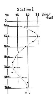
Fig. 5. — Les résistivités apparentes trouvées (station 1) et la construction de la courbe approchée des résistivités.
