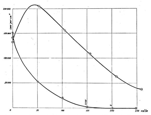
Fig. 2. — Courbes de séparation des ions positifs et négatifs. Disparition des ions positifs. Il est reporté en abscisse la différence de potentiel  $\Delta$  V appliquée au potentiomètre ( $h'' \simeq \frac{\Delta \text{ V}}{67} \text{ volt/cm}$ ). Vitesse d'air 1,2 cm/sec.
