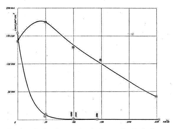
Fig. 1. — Courbes de séparation des ions positifs et négatifs. Disparition des ions négatifs. Il est reporté en abscisse la différence de potentiel  $\Delta$  V appliquée au potentiomètre  $(h' \cong \frac{\Delta V}{43} \text{ volt/cm})$ . Vitesse d'air 1,2 cm/sec.
