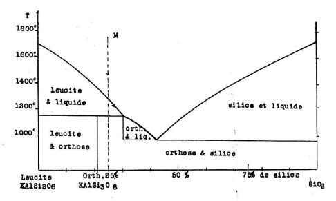
Fig. 2. — Diagramme de solidification du système  $KAlSi_2O_6 - SiO_2$  (leucite-silice).
