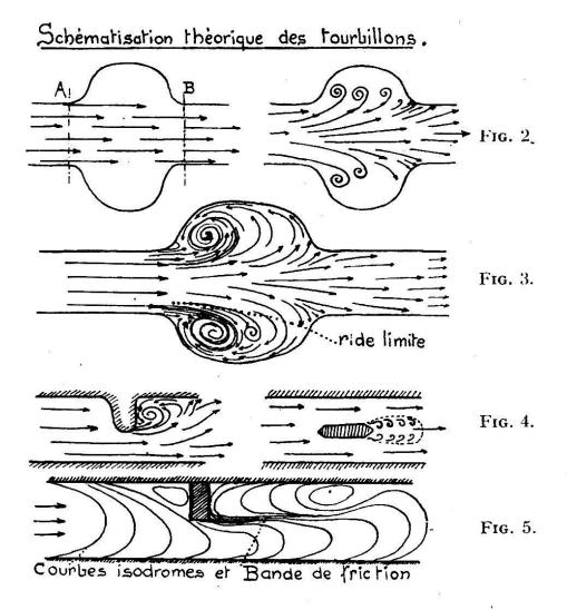
La figure 3 montre la direction moyenne probable de l'eau courante dans toutes ses strates supérieures. En vertu des différences de frottement et du choc des filets contre les éperons de l'axe B., on constate encore d'autres phénomènes remarquables en particulier des soubresauts ascendants.
