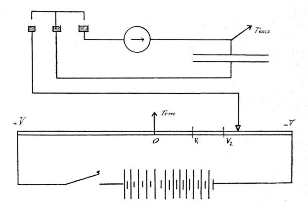
Pour opérer, on fait passer le courant dans la rigole. Puis on ferme le circuit de charge. On amène alors le plongeur, resté en O, avec une vitesse uniforme au point de potentiel  $V_1$ .
