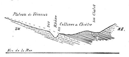
Fig. 2. — Coupes des collines de Chiètres; échelles 1:50000 pour la longueur, 2:25000 pour la hauteur.
