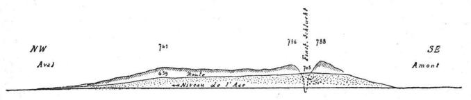
Fig. 4. — Coupe longitudinale du Kirchet, suivant la grande route, montrant le remplissage d'une ancienne gorge. Echelle 1: 25000.
