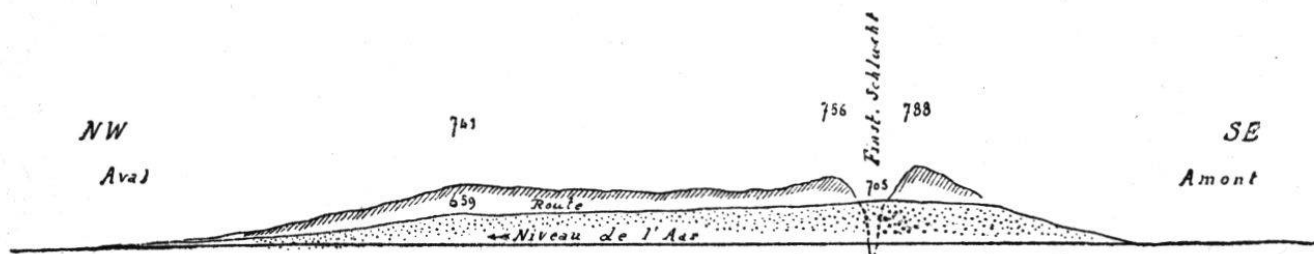
Fig. 4. — Coupe longitudinale du Kirchet, suivant la grande route, montrant le remplissage d'une ancienne gorge. Echelle 1 : 25000.
