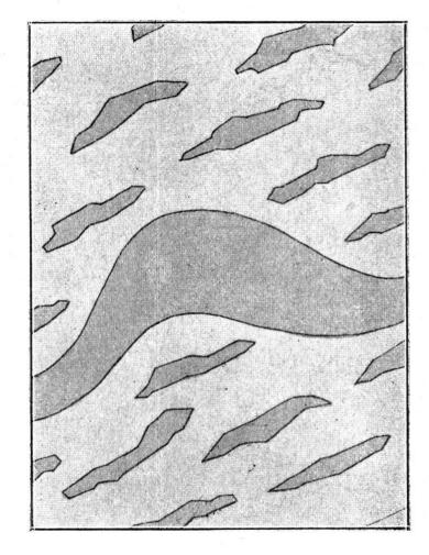
suivant la loi de Fig. 8. - Filonnet d'albite traversant la microperthite.
