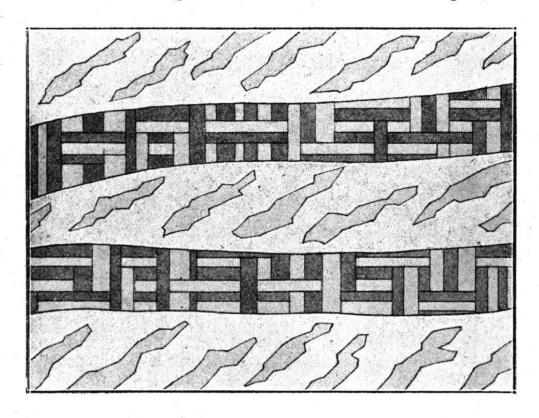
Fig. 7. — Filonnet d'oligoclase-albite traversant la microperthite.
