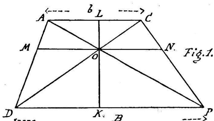
Soit le trapèze quelconque  $A C P D$ ; menons les diagonales  $A P$  et  $C D$ ; par leur point d'intersection  $O$ , menons  $M N$  parallèle aux bases  $A C$  et  $D P$ , et  $L K$  perpendiculaire à  $M N$ ; appelons  $b$  et  $B$  les deux bases parallèles.
