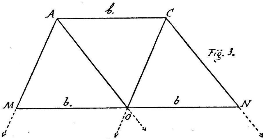
2<sup>e</sup>  $b$  peut varier entre B et zéro. Pour  $b = B$ , nous tombons dans le 1<sup>er</sup> cas et la figure est un parallélogramme.
