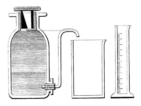
sion intérieure et extérieure, il suffit de tourner le tube de dégagement dans son bouchon et d'abaisser le col jusqu'au niveau du liquide dans le flacon. On peut tenir compte de la température, si on le juge nécessaire.
