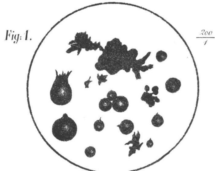
Globules résultant de la combustion du fer en poudre impalpable dans une flamme de gaz hydrogène!
