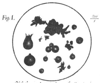
Globules resultant de la combustion du fer en pondre impalpable sans une flamme de aazo hydrogène!
