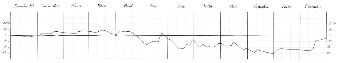
La surface du vasc expose à la chute de la pluie et à l'évaporation est de 1965 centimètres carrès. Les portions ascendantes de la courbe courespondent aux excés de chute; les portions descendantes, aux excés d'évaporation.
