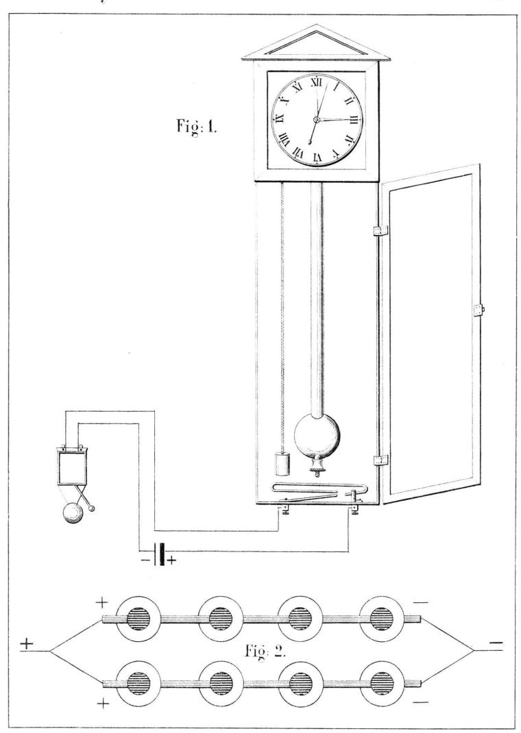
Cet appareil peut fonctionner avec la pile qui transmet le mouvement aux cadrans; cependant si l'on a déjà un système de sonneries électriques dans le bâtiment où se trouve le régulateur, il sera préférable d'utiliser le courant d'une pile indépendante.
