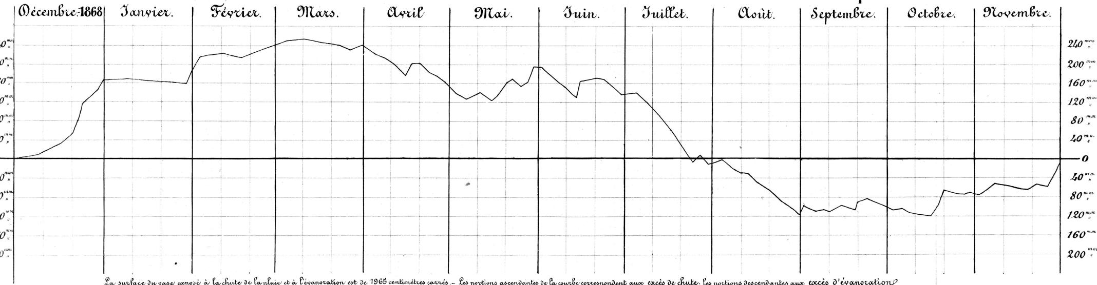
La surface du vase exposé à la chute de la pluie et à l'évaporation est de 1965 centimètres carrés. — Les portions ascendantes de la courbe correspondent aux excès de chute; les portions descendantes, aux excès d'évaporation.
