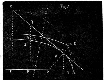
ce point nous menons l'ordonnée PM, et par le point A la verticale AD. Du point A comme centre et arc AP pour rayon, nous traçons l'arc Pd qui coupe AD en d, nous joignons le point d au point e, et la ligne ed est une tangente à l'ellipse au point M qui se trouve ainsi déterminé. Nous menons la normale MN et sur son prolongement nous portons Mm égale à 2 Bc, Bc étant l'épaisseur de la voûte à la clé, calculée comme il a été dit pour les voûtes plein-cintre.
