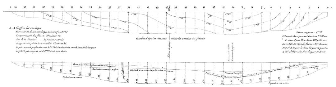
Courbes exprimant les vitesses à la surface. Les vitesses à différentes profondeurs pour un point de la section?, et la force mécanique dufleuve en chevaux-vapeur.
