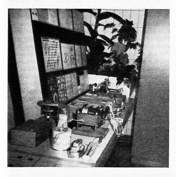
Lauter von den Schülern unter Anleitung des Lehrers selbsthergestellte elektrische Apparate und Einrichtungen: Bügeleisen aus Sardinenbüchse, Glühlampe aus Joghurtbecher, Elektromotor aus Fadenspule, Nägeln und Kupferdraht u. a. m.
