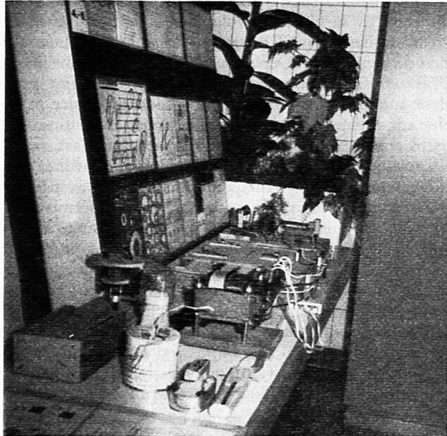
Lauter von den Schülern unter Anleitung des Lehrers selbsthergestellte elektrische Apparate und Einrichtungen: Bügelseisen aus Sardinenbüchse, Glühlampe aus Joghurtbecher, Elektromotor aus Fadenspule, Nägeln und Kupferdraht u. a. m.
