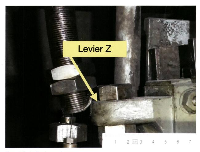
Figure 2. Levier Z endommagé
