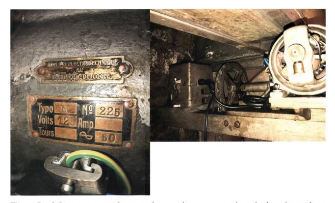
Figures 7 et 8. Le moteur servant à remonter la masse du mouvement qui entraine le papier, sa plaque signalétique, son origine (École d'électrotechnique du Technicum du Locle) et son installation avec à gauche le relais servant à enclencher et déclencher le moteur.
