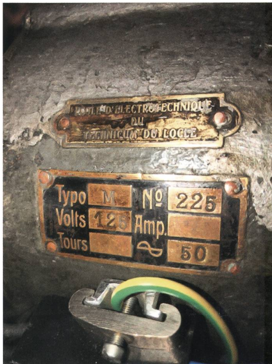
Figures 7 et 8. Le moteur servant à remonter la masse du mouvement qui entraîne le papier, sa plaque signalétique, son origine (École d'électrotechnique du Technicum du Locle) et son installation avec à gauche le relais servant à enclencher et déclencher le moteur.
