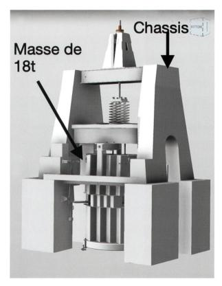
Figure 4. Modèle 3D du sismographe
