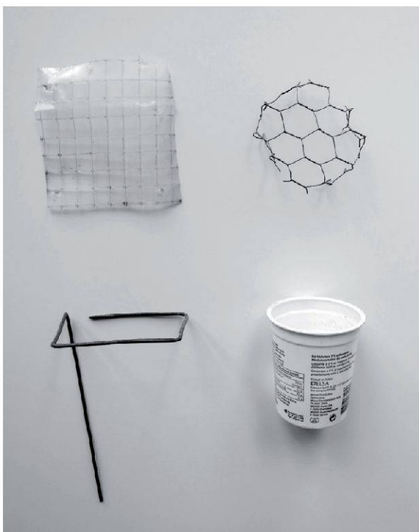
Figure 1 : Détail des éléments utilisés pour les pièges Barber (photo : Matthias Borer).
