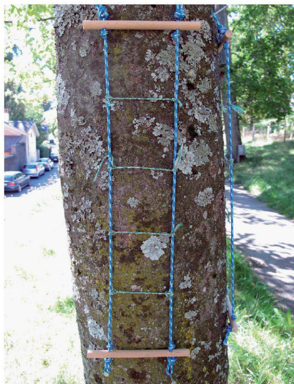
Figure 2 : Relevé de bioindication : quatre grilles, chacune composée de 5 carrés de 10x10 cm, sont placées sur le tronc à 1.5 m du sol, aux 4 points cardinaux.
