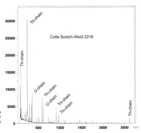
**Figure 4**: spectre de la "Scotch-Weld 2216", la colle la plus active que nous ayons mesurée.
