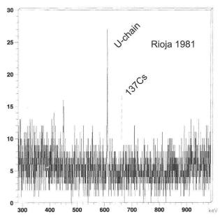
**Figure 7**: spectres obtenus des vins de Rioja 1964 et 1981: le spectre du <sup>137</sup>Cs est clairement visible pour celui de 1964 (à gauche), alors qu'il n'existe pas pour celui de 1981 (à droite).
