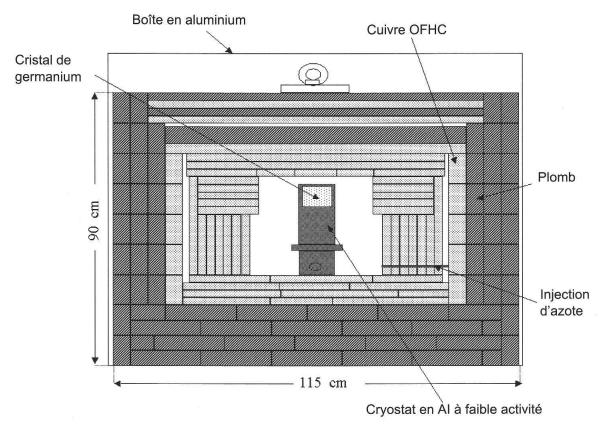
Figure 1: dessin technique du blindage du détecteur. Le tout est pressurisé à l'azote.
