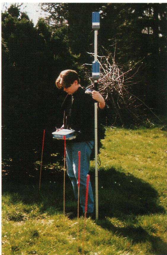
Fig.3a: Photographie illustrant le dispositif de mesure VLF-EM motorisé, avec l'antenne automatique, la télécommande de l'antenne, l'instrument pour mesurer les paramètres VLF ( H_s/H_p [%]), le data-logger et l'ordinateur portable.
