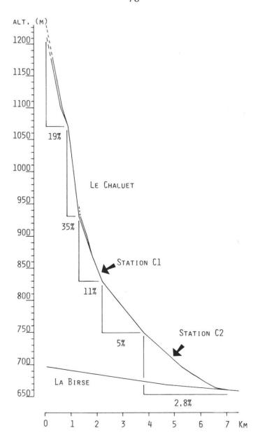
Fig. 1. Profil longitudinal du Chaluet.
