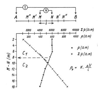
Fig. 4. Schéma du sondage cumulatif de MOORE (1952) et de son interprétation empirique.  $C_1$  et  $C_2$ : première et deuxième couches; A et B: électrodes de courant; M et N: électrodes de potentiel;  $\rho(\Omega m)$ : la résistivité apparente; K: coefficient géométrique du dispositif.
