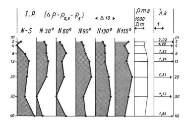
Fig. 7. Sondages géoélectriques pluridirectionnels: l'effet de la polarisation induite (I.P.) en fonction de la profondeur, comparé aux résistivités apparentes moyennes ( $\rho_{ma}$ ) et aux coefficients d'anisotropie apparente ( $\lambda_a$ ).
