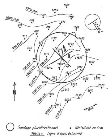
Fig. 3. Schéma de la fracturation dans la région de la Baume (I = tension; II = raccourcissement; D = décrochement) et les profils de la résistivité apparente sur le site expérimental (AB fixe = 160 m; MN = 10 m).
