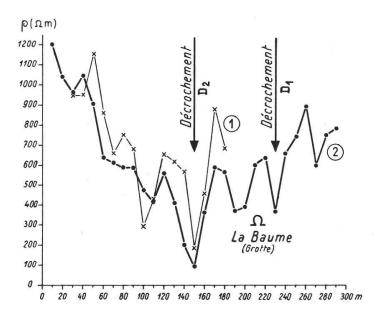
Fig. 6. Profils géoélectriques exécutés à l'aide d'électrodes de courant fixe (Fixed Current Electrod Array: FCE). 1 = AB 200 m; 2 = AB 500 m. MN = 10 m. Les profondeurs d'investigations sont respectivement de 20 et 50 m au moins.
