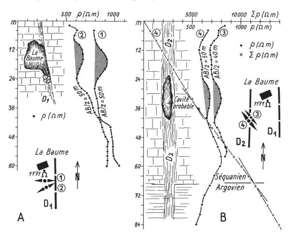
Fig. 5. Les sondagses géoélectriques de «Moore» sur la cavité connue (A) et sur le décrochement D<sub>2</sub> (B) (cf. fig. 1). Le réseau est localisé par des «poches» de résistivité (en grisé).
