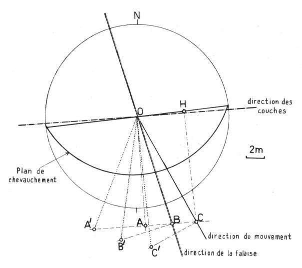
Fig. 3. Reconstruction des rejets du chevauchement 4a — 4a.
