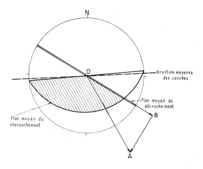
Fig. 4. Relations spatiales entre les principaux éléments structuraux de la carrière.  $\overrightarrow{OA} = \text{mouvements}$  des bloc II et zone III. Le déplacement peut être décomposé en une composante parallèle au décrochement  $(\overrightarrow{OB})$  et une composante perpendiculaire à la direction du décrochement  $(\overrightarrow{BA})$ .
