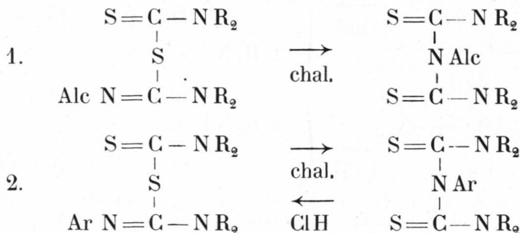
Ce phénomène de la transposition a été constaté d'autre part par Dixon chez les dérivés acidiques des pseudo-thiurées, transposition qu'il envisage de la façon suivante, avec l'acétyl-o-tolylthiurée par exemple :
