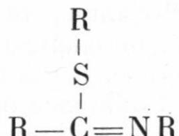
la série des corps rouge contient le soufre en double liaison sur un atome de carbone, soit le chromophore  $\text{C}=\text{S}$  :
