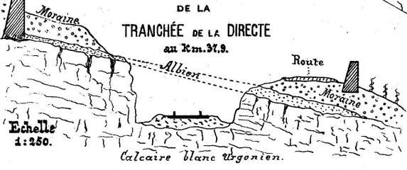
Fig. 3. COUPE LONGITUDINALE DU FLANC N-W. DE LA TRANCHÉE DE «LA DIRECTE» BERNE-NEUCHÂTEL, ENTRE LES POINTS KILOMÉTRIQUES 37.700 ET 38.050, AU-DESSOUS DE LA COUDRE
