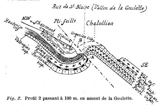
Il est évident qu'il y a là un accident géologique important et la conclusion découlant des faits observés consiste à admettre un pli-faille, ainsi que cela a été dessiné dans le profil ci-dessus. Ce même pli-faille nous explique aussi le voisinage anormal de l'Urgonien supérieur et du Valangien, exposé précédemment.
