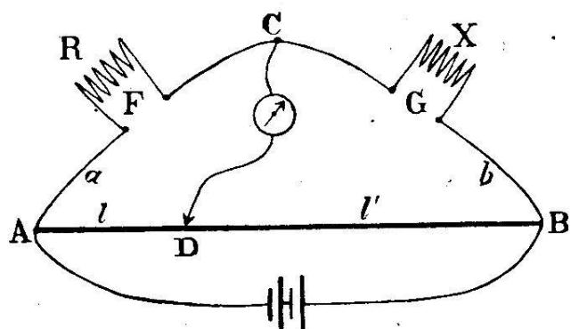
Le désir d'échapper à ces erreurs a conduit aux méthodes et aux modifications du pont de Wheatstone connues sous les noms de : méthode du galvanomètre différentiel, méthode de Matthiesen et Hockin, méthode de Thomson, etc.
