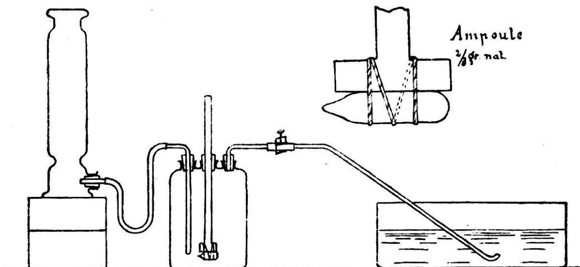
Le siliciure de magnésium est introduit dans une ampoule en verre mince, complètement fermée, qu'on attache au moyen d'une ficelle à l'extrémité élargie et aplatie d'une forte baguette de verre. Celle-ci est fixée au moyen d'un bouchon dans la tubulure du milieu d'un flacon de Woulff à trois tubulures, de telle manière que l'ampoule se trouve au fond du flacon. Ce flacon communique par la deuxième tubulure avec une cuve à eau au moyen d'un tube à robi-
