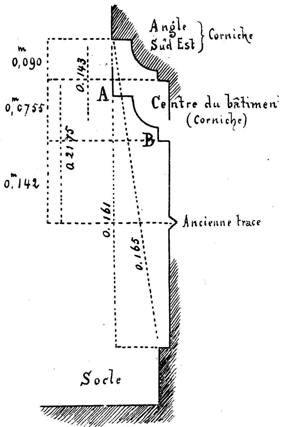
$0^m,090 + 0^m,2175 - 0^m,1535 = 0^m,154$  pour correspondre avec la moyenne  $0^m,1535$  du nivelllement direct fait en 1854.
