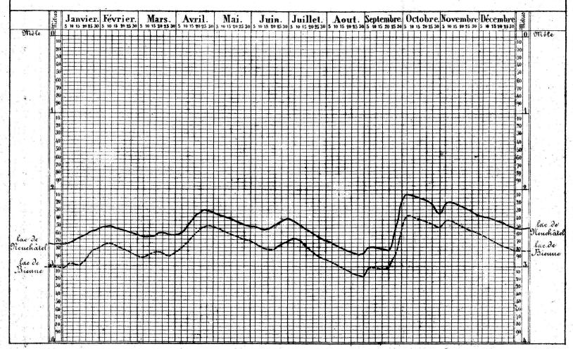
Tableau de la hauteur des eaux des lacs de Neuchâtel Bienne et Morat au dessous du môle de Neuchâtel dans l'année 1862. Le môle de Veuchâtel est à 1317 au dessus du niveau de la mer
