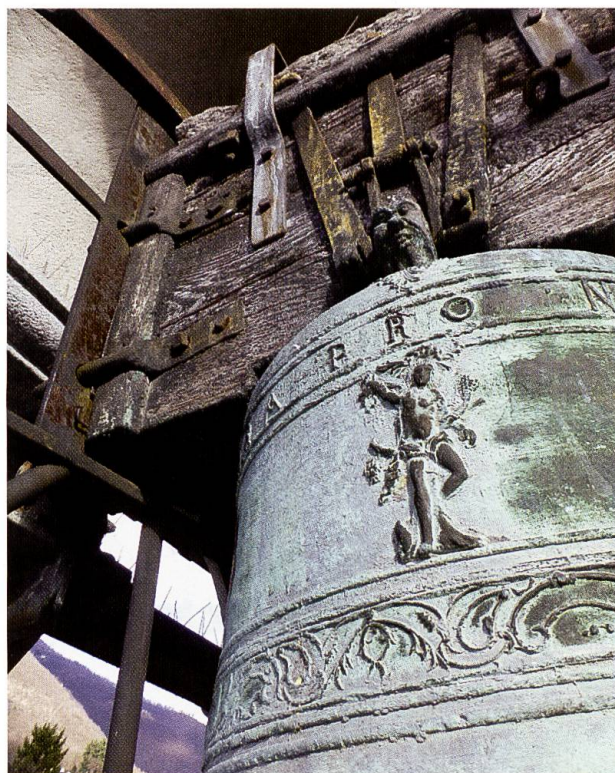
Dettaglio della campana minore di Locarno Monti, fusa da Giovanni Giacomo Bustelli nel 1776. La fusione è molto pulita e i decori sono di notevole qualità.
