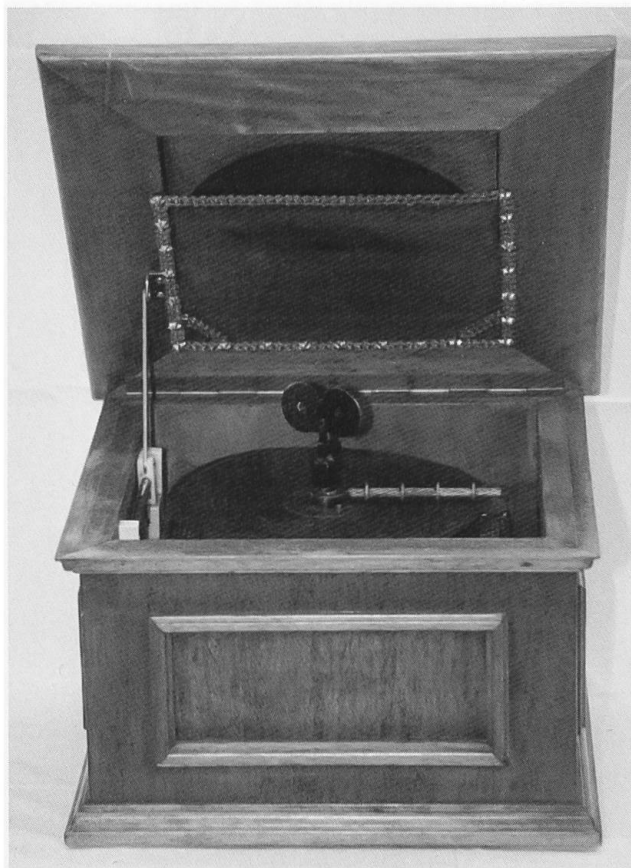
Riproduttore musicale di dischi in metallo perforato, a percussione. Marca Carillon, 1922. Collezione Sergio Morasci, Gordola.
