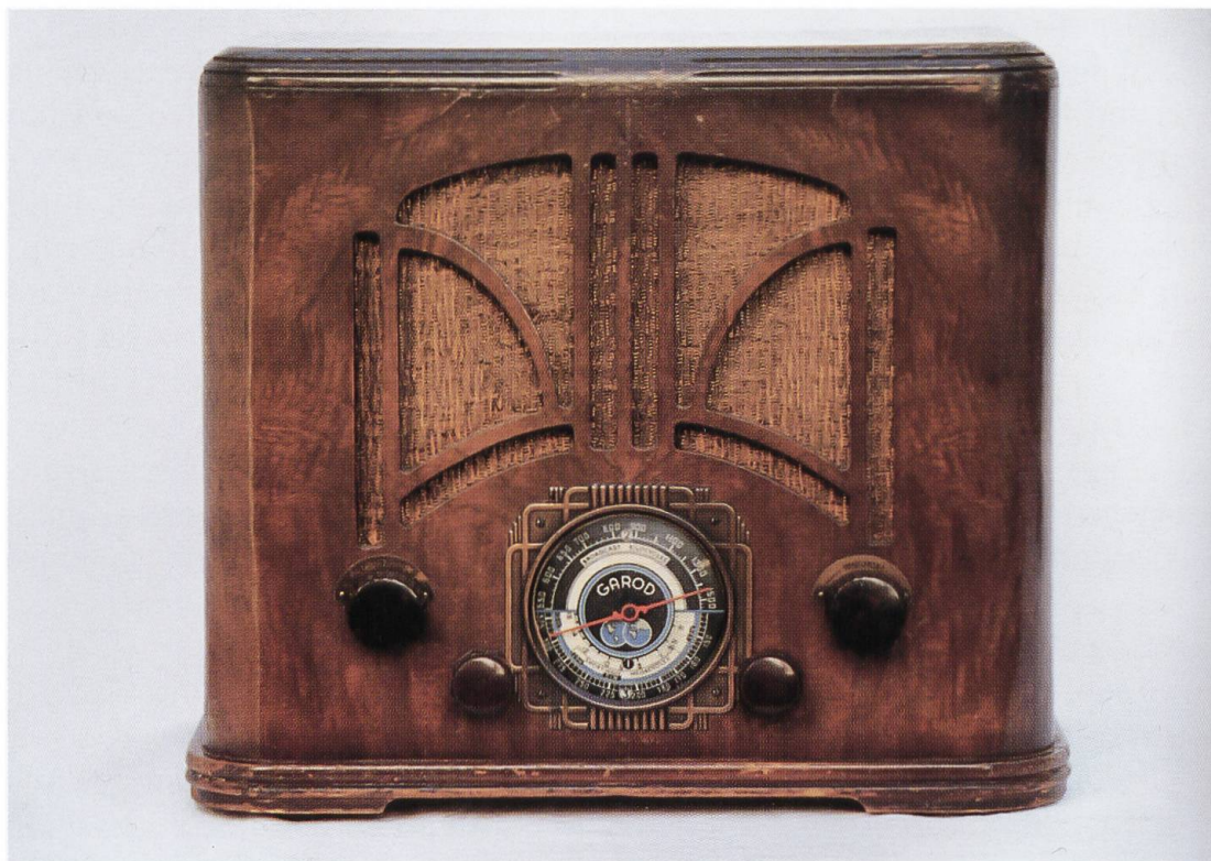
Radio a 6 valvole, 3 lunghezze d'onda, supereterodina, altoparlante elettrodinamico. Marca Garod, di fabbricazione americana, 1938/39. Collezione Sergio Morasci, Gordola.
