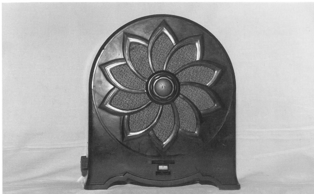
Apparecchio radio a 4 valvole, circuito a sezione, blocco AF con bobine a nido d'ape. Mobile in bachelite, 1924. Collezione Sergio Morasci, Gordola.
