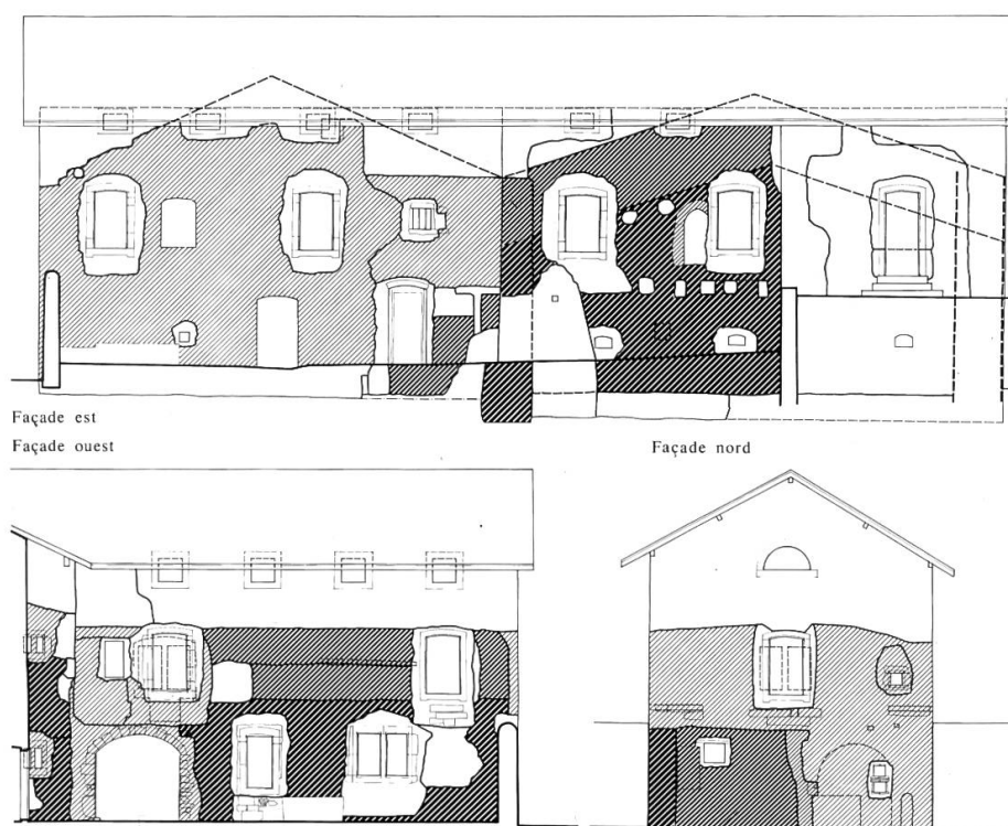
Fig. 37. Relevés schématiques des façades du n° 35 de la rue du Midi, avec l'indication des étapes de construction.
