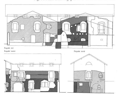
Fig. 37. Relevés schématiques des façades du nº 35 de la rue du Midi, avec l'indication des étapes de construction.
