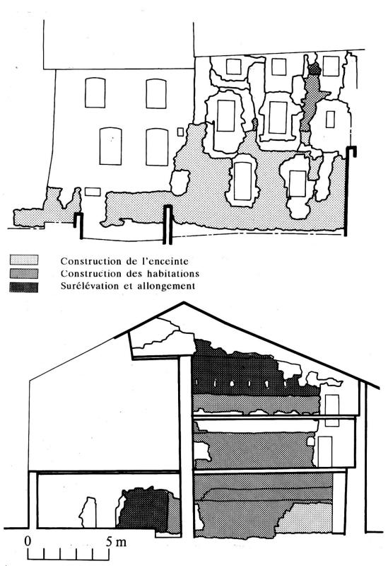
Fig. 15. Schéma montrant les trois étapes de construction de l'enceinte et du mur mitoyen ouest du nº 26 de la rue du Nord aux XIIIº et XIVº siècles.
