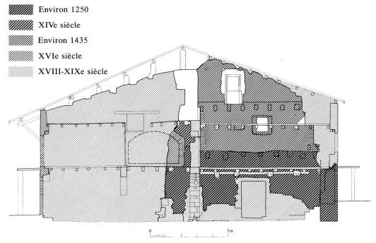
Fig. 20. Relevé schématique du mur mitoyen ouest du nº 34 de la rue du Nord, avec le report des étapes de construction.
