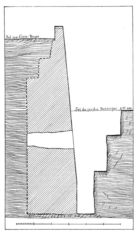
Fig. 2. — Coupe sur le mur d'enceinte du XVI<sup>me</sup> siècle relevée sur l'emplacement de la fouille.
