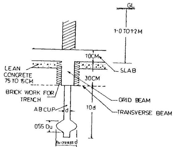
FIG4-A VIEW OF JUNCTION OF BEAM SLAB & ABCUP
